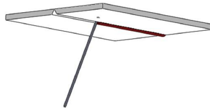
Overhead welding PE (4G*)
